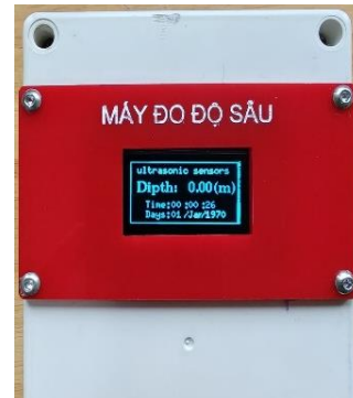
Hình 4. Màn hình hiển thị OLED trên thiết bị đo độ sâu.
