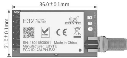
Hình 2. Module thu phát LoRa E32-433T20D [11].
