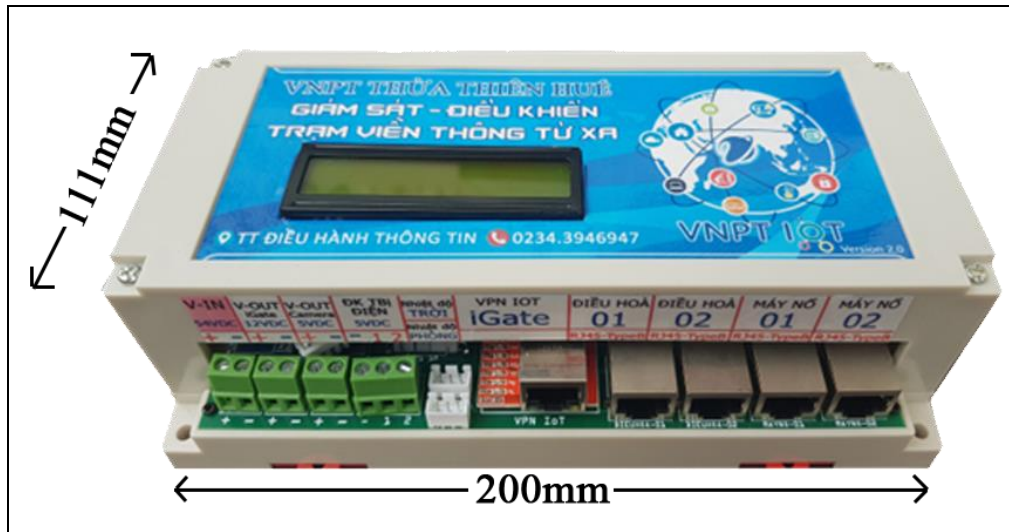
Hình 3. Hộp điều khiển lắp đặt trong nhà trạm
