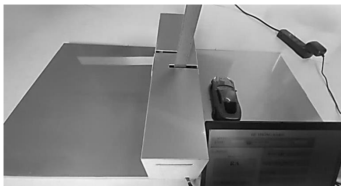
Hình 12. Barrier chưa hạ xuống khi cảm biến phát hiện xe vẫn chưa di chuyển qua.
