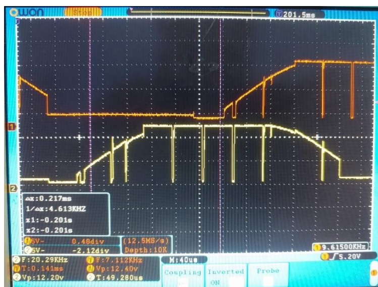
Hình 8. Tín hiệu ở Pha A và Pha B khi PWM cực đại
