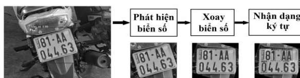
Hình 5. Sơ đồ khối các bước nhận diện biển số xe.
