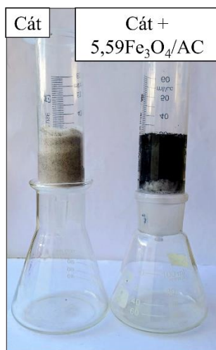
Hình 10. Cột hấp phụ chứa cát và hỗn hợp trộn đều của 10 gam cát và 3 gam vật liệu 5,59\text{Fe}_3\text{O}_4/\text{AC} .
