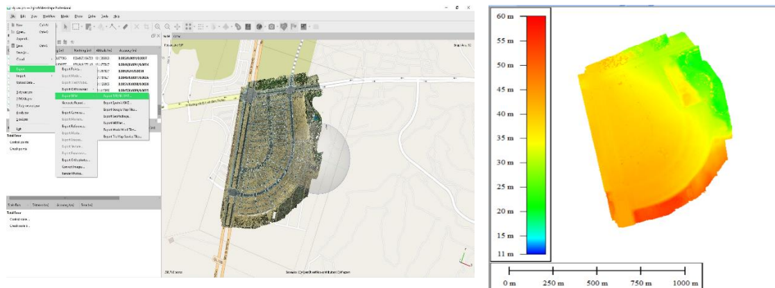
Hình 8. Xử lý ảnh tạo mô hình DEM bằng phần mềm Agisoft
