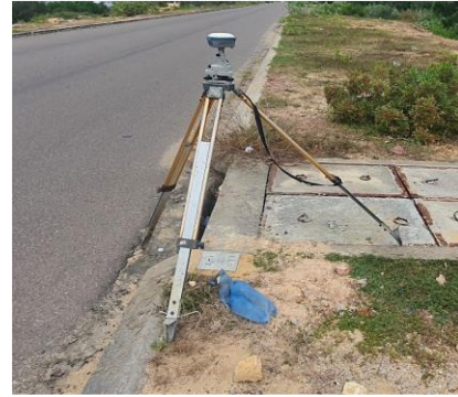
Hình 6. Trạm tĩnh GNSS-PPK đo liên tục trong quá trình bay chụp
