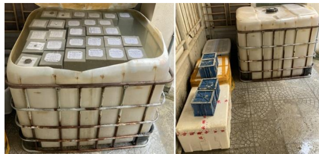
(a) Bảo dưỡng mẫu bê tông trong môi trường nước trước 28 ngày tuổi
