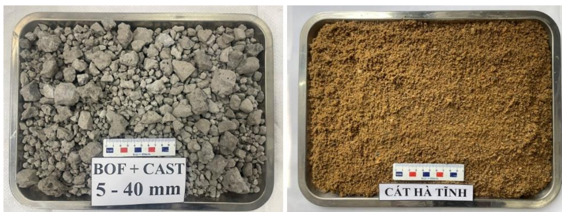
Hình 1. Ảnh chụp mẫu hỗn hợp xi thép BC540 và cát Hà Tĩnh sử dụng làm cốt liệu lớn và cốt liệu nhỏ cho bê tông xi thép BC540.
