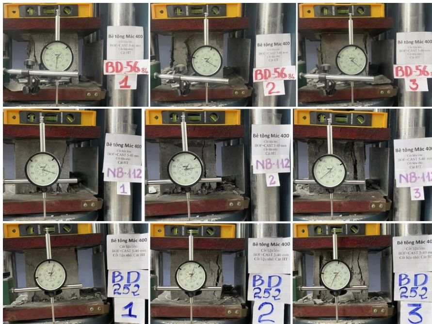
Hình 6. Ảnh chụp đại diện mẫu bê tông xỉ thép BC540 bị phá hủy sau thí nghiệm xác định cường độ chịu nén ở 84, 140 và 252 ngày tuổi.
