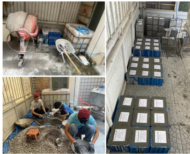
Hình 3. Ảnh chụp chuẩn bị thiết bị, vật liệu và chế tạo mẫu bê tông xi thép BC540
