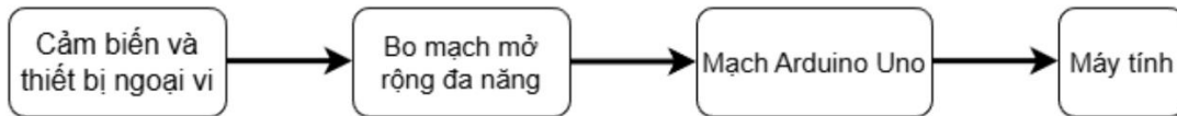
Hình 1. Sơ đồ khối của shield mở rộng đa chức năng cho Arduino.
