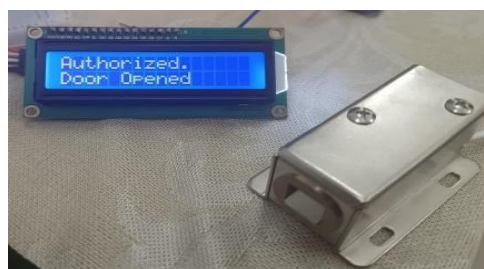
Hình 5. Màn hình LCD hiển thị đã nhận diện thành công khuôn mặt và thẻ RFID, khóa điện cho phép mở cửa.
